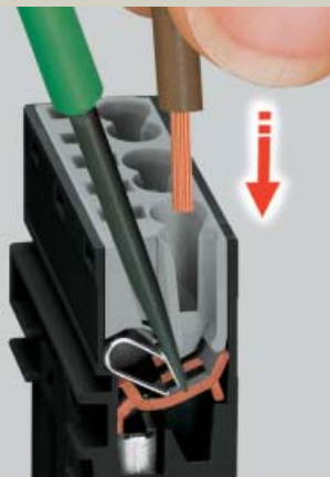
Подключение многожильных проводников: открыть зажим отверткой и вставить зачищенный провод до отказа
