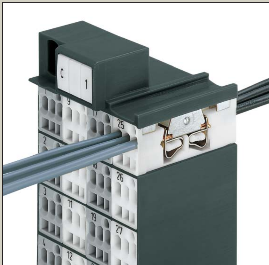
Дополнительный модуль с защелкой и контактом к монтажному каркасу
