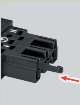
Перевернуть кодировочный штифт на 180° и вставить его в штеккер.
