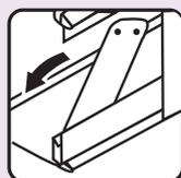
Повернуть фиксатор по окончании монтажа кабеля.
