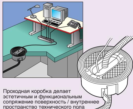
Проходная коробка делает эстетичным и функциональным сопряжение поверхность / внутреннее пространство технического пола
