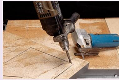
1. После прочерчивания по шаблону, просверлить отверстия по 4-м углам и применить лобзик
