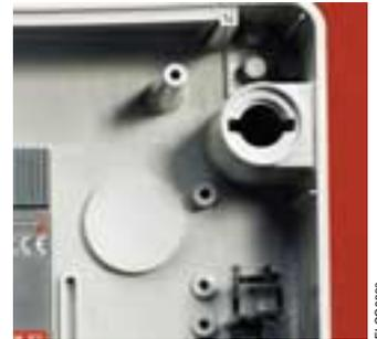
▲ Если шкаф крепится к стене через отверстия внутри шкафа, то для обеспечения двойной изоляции на эти отверстия надеваются специальные колпачки.
